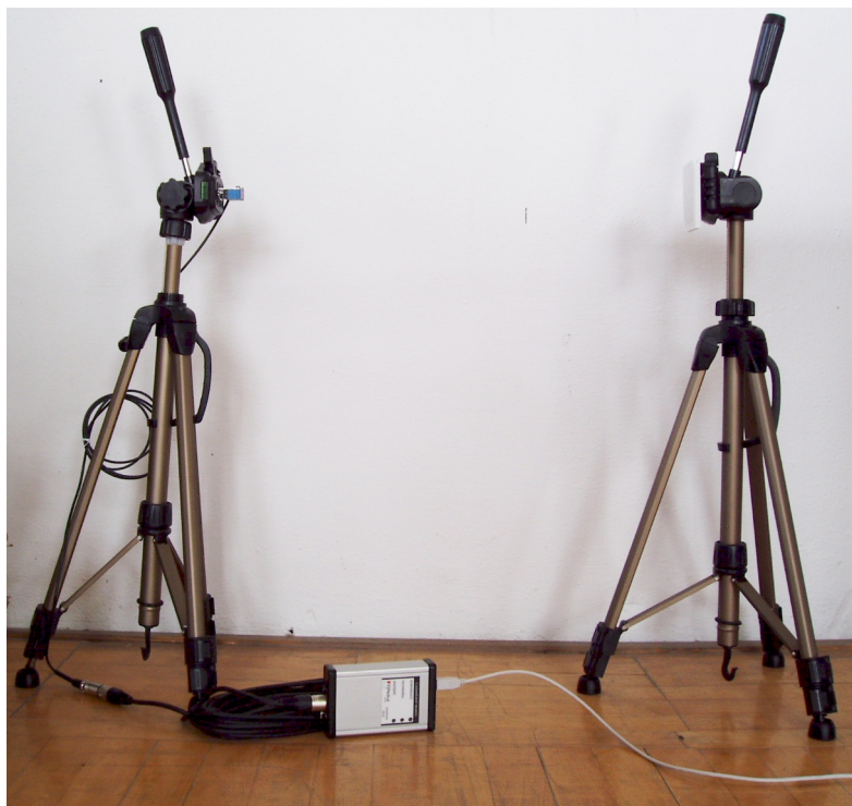
Obr. 2.1: Postavení fotobuněk; směr montáže fotobuňky se může lišit!
